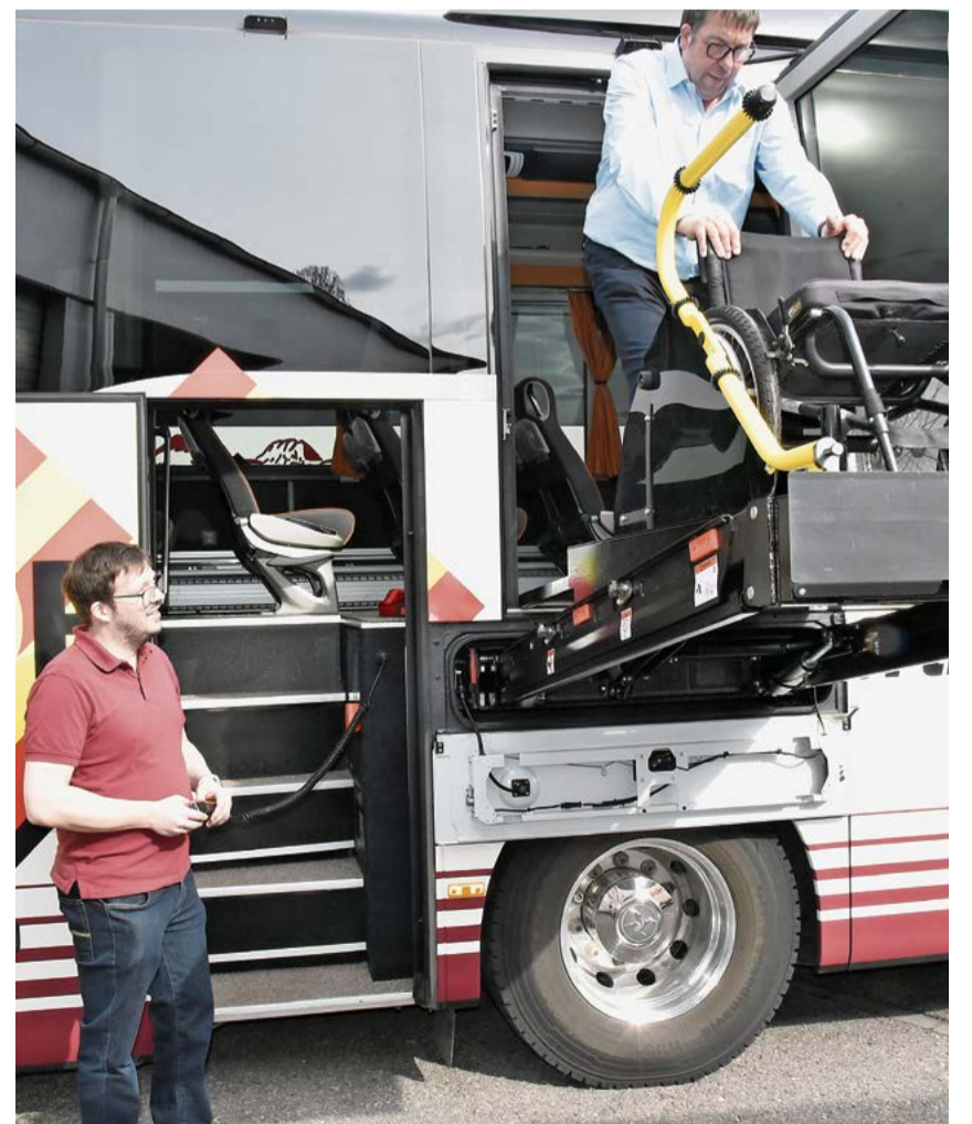
Richard Moser (oben) und Raphael Moser demonstrieren, wie die Hebebühne für Rollstuhlfahrende funktioniert.
